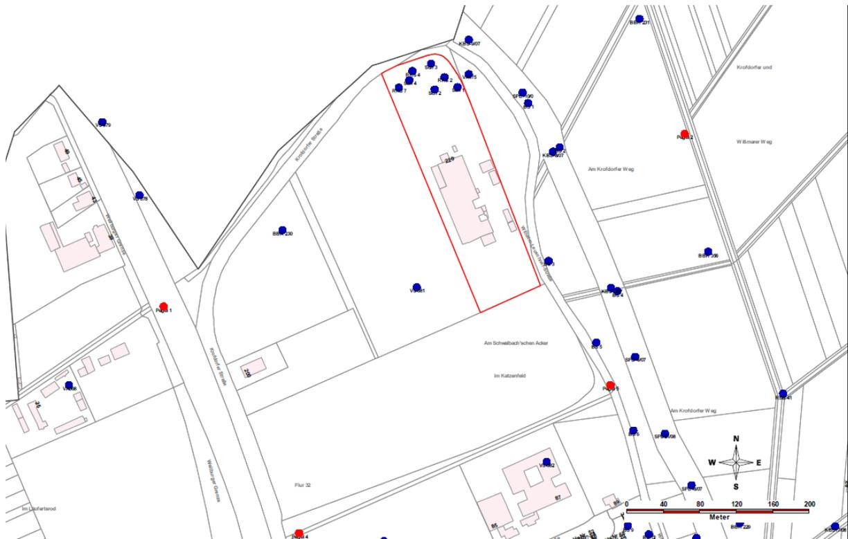
Abbildung 31: Lageplan „Bohrungen und Grundwasserpegel“<sup>36</sup> (unmaßstäblich)
